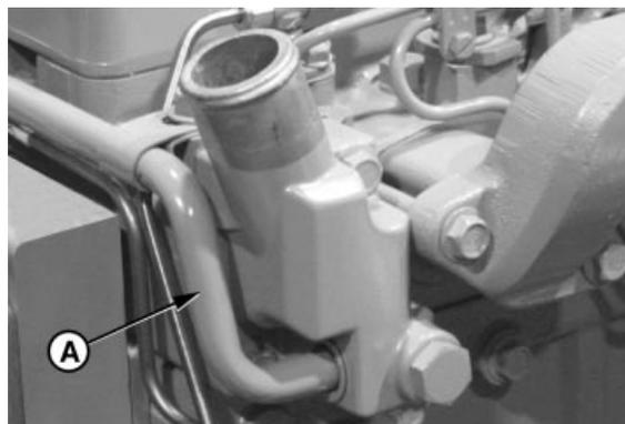
Tubo entre la caja de termostatos y la bomba de agua
