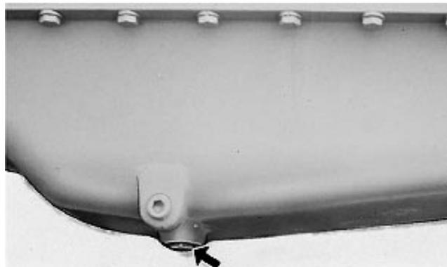
Tapón de vaciado del cárter
