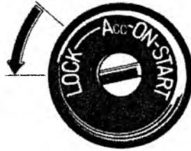
START – в этом положении работает стартер. После того, как двигатель начнет работать, а ключ зажигания будет отпущен, ключ автоматически вернется в положение ON.
