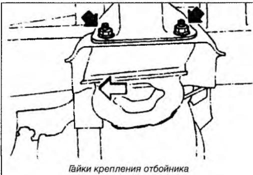
Гайки крепления отбойника
