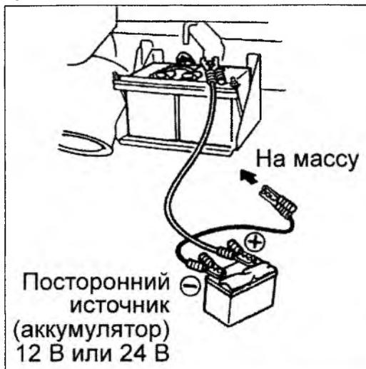
**ВНИМАНИЕ!** Если порядок подключения проводов к аккумулятору будет отличаться от показанного на рис., это может вызвать короткое замыкание или искрение контактов. Порядок отсоединения проводов противоположен порядку подключения.
