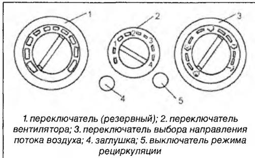
1. переключатель (резервный); 2. переключатель вентилятора; 3. переключатель выбора направления потока воздуха; 4. заглушка; 5. выключатель режима рециркуляции
