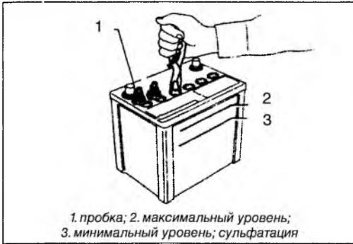
Если аккумулятор долго не обслуживался, в него доливали грязную (не дистиллированную) воду, плотность электролита упала ниже 1,00, или аккумулятор был сильно разряжен, это может вызвать глубокую сульфатацию пластин аккумулятора. При глубокой сульфатации аккумулятора его емкость не восстанавливается, сколько бы ни пропускали через него ток заряда.
