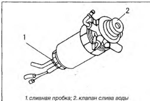
1. сливная пробка; 2. клапан слива воды
